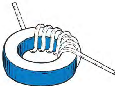
Fig.8 Se l'avvolgimento viene effettuato in modo da ricoprire meno della metà della sua circonferenza, il valore della induttanza da noi calcolato aumenterà di circa 1,7 volte.
