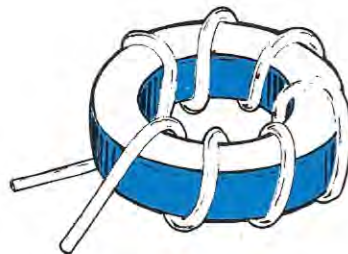
Fig.6 Il valore in microhenry ricavato con la formula da noi riportata corrisponderà solo se l'avvolgimento ricopre la totale superficie circolare del nucleo. Se le spire da avvolgere sono poche (4-5-6 spire) le dovrete spaziare.
